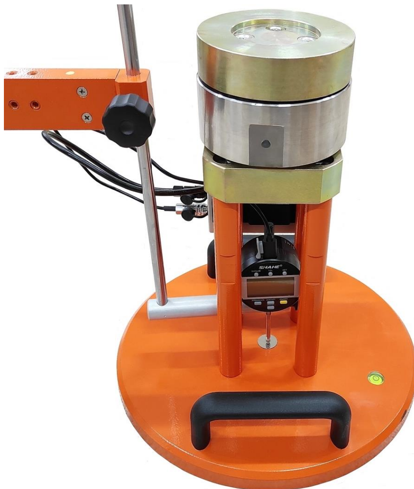
Рисунок 31 – Установка датчика перемещения
